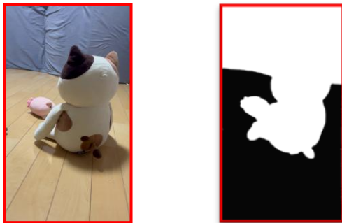
図 3 フレーム(左)とそのマスク(右)の例。マスクが見えやすいように画像を赤枠で囲っている。床が黒で、床以外が白になっていることがわかる。
